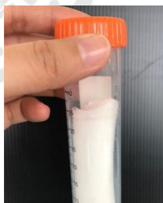
ญ แสดงตัวอย่าง MeHA hydrogel หลัง lyophilization
