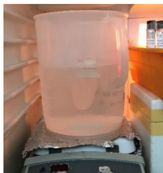
จ แสดงตัวอย่างการ dialysis สารละลาย MeHA hydrogel
