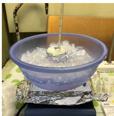
ก แสดงตัวอย่างการสังเคราะห์ MeHA hydrogel
