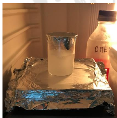
ง แสดงตัวอย่างการ stir สารละลาย MeHA hydrogel ในตู้เย็นจนครบ 24 ชั่วโมง
