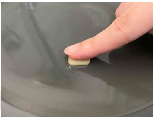
ภาพประกอบ 20 แสดงการขัดผิวแผ่นเรซินสีเหมือนฟันด้วยเครื่องขัดผิววัสดุ
