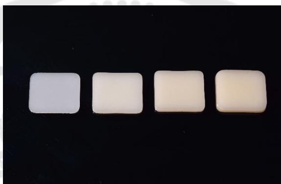
ภาพประกอบ 16 แสดงแผ่นเซรามิกความหนา 0.5, 1.0, 1.5 และ 2.0 มิลลิเมตรที่ผ่านการเคลือบผิวและเผาแล้ว
