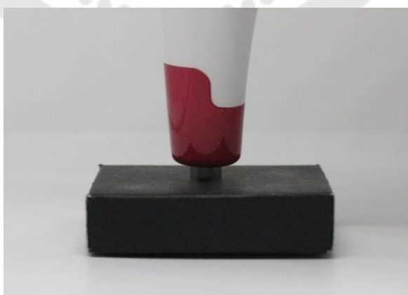
ภาพประกอบ 28 แสดงการวัดค่าสีชิ้นงานด้วยเครื่องสเปกโตรโฟโตมิเตอร์
