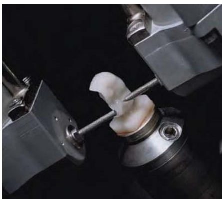
ภาพประกอบ 3 แสดงขั้นตอนการกลึงชิ้นงานด้วยระบบแคด/แคม
