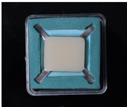
ภาพประกอบ 25 แสดงการปิดทับแผ่นเรซินสีเหมือนฟันและตัวคั่นด้วยแผ่นเซรามิก
