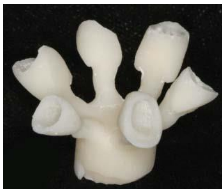
ภาพประกอบ 1 แสดงภาพเซรามิกที่ยังติดอยู่กับสปรู (Sprue) จากการอัดขึ้นรูปด้วยความร้อน
