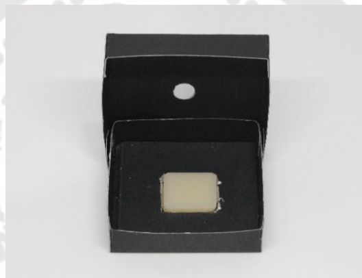
ภาพประกอบ 27 แสดงกล่องดำสำหรับวัดค่าสีชิ้นงาน
