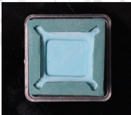
ภาพประกอบ 23 แสดงบล็อกสำหรับใช้ในขั้นตอนการยัดเรซินซีเมนต์
