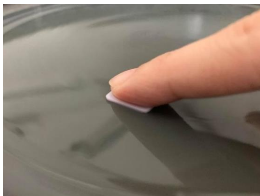
ภาพประกอบ 13 แสดงการขัดผิวแผ่นเซรามิกด้วยเครื่องขัดผิววัสดุ
