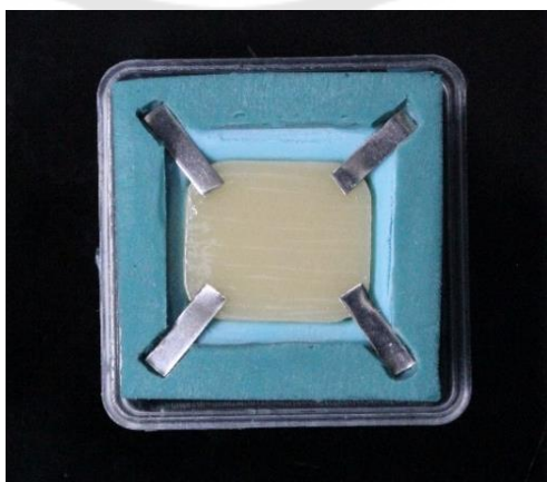
ภาพประกอบ 24 แสดงการใช้แผ่นฟอยล์โลหะไว้คั่นมุมระหว่างแผ่นเซรามิกและแผ่นเรซินสีเหมือนฟัน
