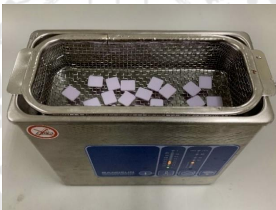
ภาพประกอบ 14 แสดงการทำทำความสะอาดแผ่นเซรามิกด้วยเครื่องล้างความถี่สูง
