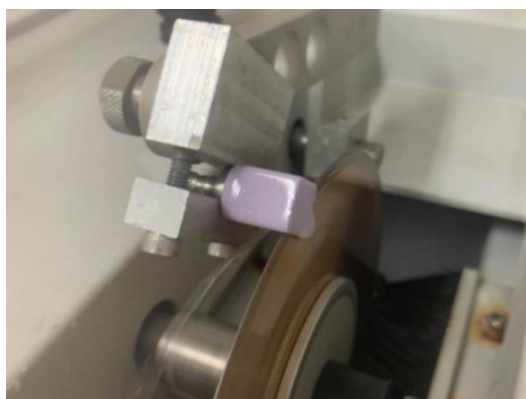
ภาพประกอบ 11 แสดงการตัดบล็อกเซรามิกด้วยเครื่องตัดใบเลื่อยเพชร
