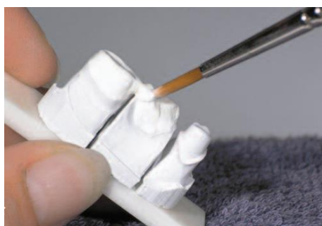
ภาพประกอบ 2 แสดงขั้นตอนการทาสลิปลงบนยิปซัมตายในวิธีขึ้นรูปเซรามิกแบบสลิปแคสติ้ง
