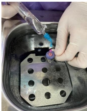
ภาพประกอบ 14 จำลองการล้างคลองรากฟันภายใต้อุณหภูมิ 37 องศาเซลเซียส โดยใช้อ่างน้ำ ควบคุมอุณหภูมิที่ 37 องศาเซลเซียส (water bath)
