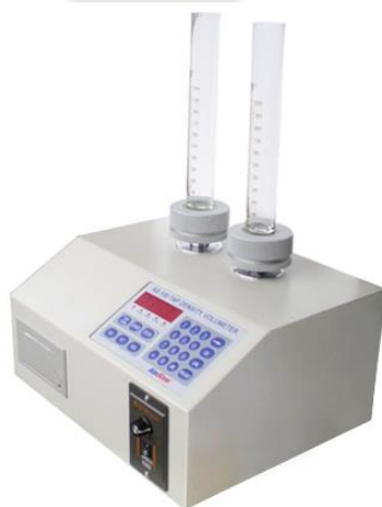
ภาพประกอบ 12 เครื่องเคาะผงยา (tapping apparatus)
