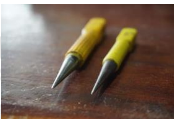
ภาพประกอบ 45 แสดงภาพตุ้ดตู่ 2 ขนาด คือปลายแหลมมน, ปลายแหลมเล็ก
