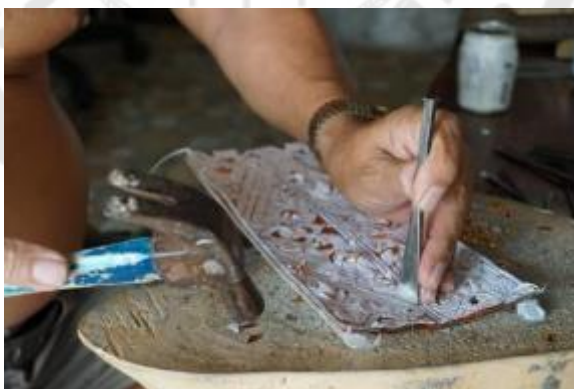
ภาพประกอบ 30 แสดงการตอกกระดาษ โดยใช้สั้วหลากหลายขนาด
