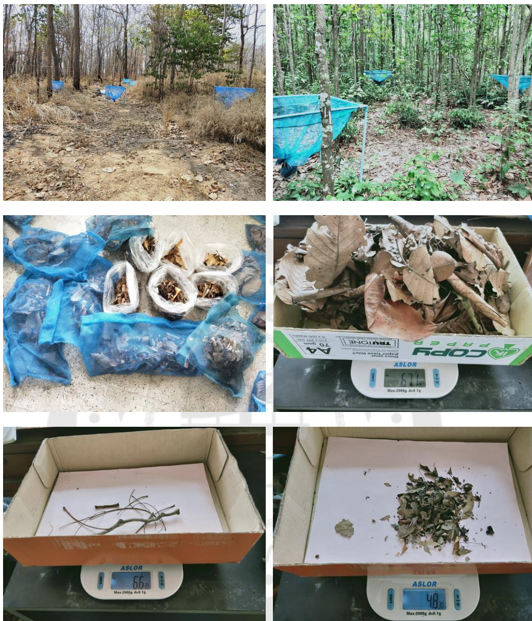
ภาพประกอบ 57 การติดตั้งอุปกรณ์ การเก็บตัวอย่าง และการวิเคราะห์ตัวอย่างผลผลิตเศษซาก ชีวมวล ในป่าเต็งรังปฐุมภูมิและทุติยภูมิ
