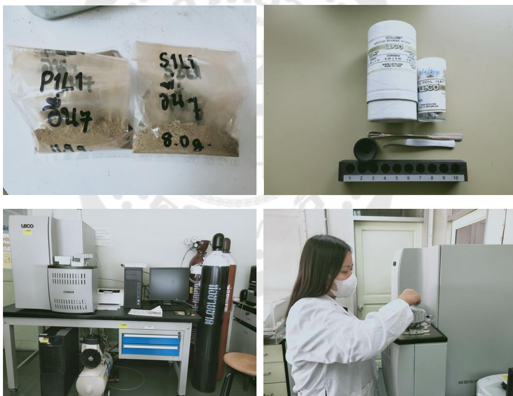
ภาพประกอบ 62 การเตรียมตัวอย่างและการวิเคราะห์ปริมาณคาร์บอนและไนโตรเจน ด้วยเครื่อง CHN analyzer รุ่น 628
