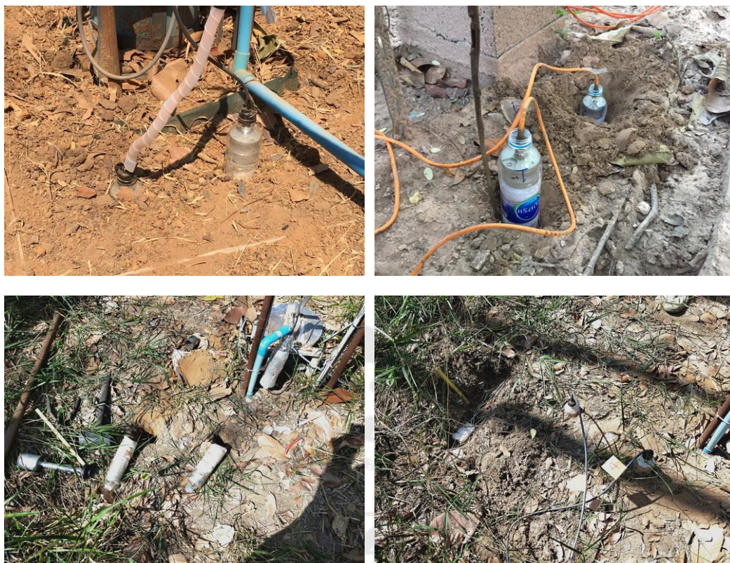
ภาพประกอบ 59 การติดตั้งอุปกรณ์ตรวจวัดการปลดปล่อยก๊าซคาร์บอนไดออกไซด์ (carbon dioxide probe รุ่น GMP343) ในป่าเต็งรังปฐุมภูมิ จังหวัดนครราชสีมา
