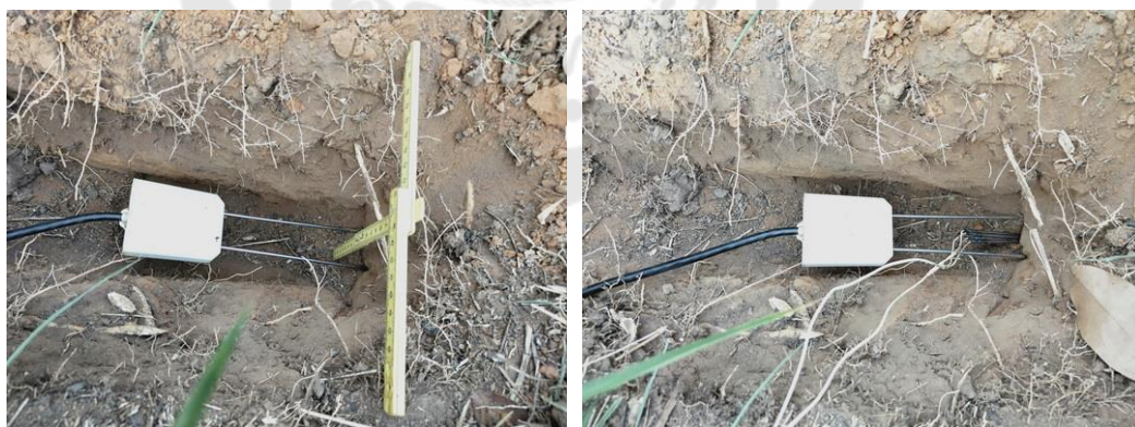
ภาพประกอบ 60 การติดตั้งอุปกรณ์ตรวจวัดอุณหภูมิและความชื้นในดิน
