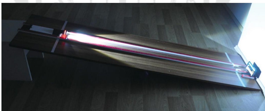
ภาพประกอบ 45 ชุดการทดลองสำหรับหาค่าความเร่งและอัตราเร็วปลาย โดยใช้เซนเซอร์วัดแสง
