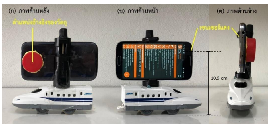
ภาพประกอบ 48 ชุดรถทดลองที่พัฒนาขึ้นจากหัวรถไฟของเล่นแบบใส่ถ่านพร้อมติดตั้งสมาร์ทโฟน (ก) ภาพด้านหลัง (ข) ภาพด้านหน้า (ค) ภาพด้านข้าง
