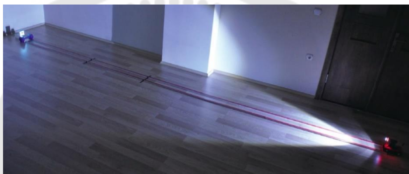
ภาพประกอบ 44 ชุดการทดลองสำหรับหาค่าอัตราเร็วเฉลี่ย โดยใช้เซนเซอร์วัดแสงของสมาร์ทโฟน
