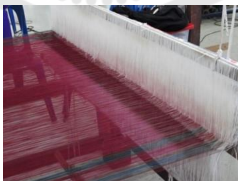
ภาพประกอบ 64 ตะกอลั่น (ตะกอฟั่น)
