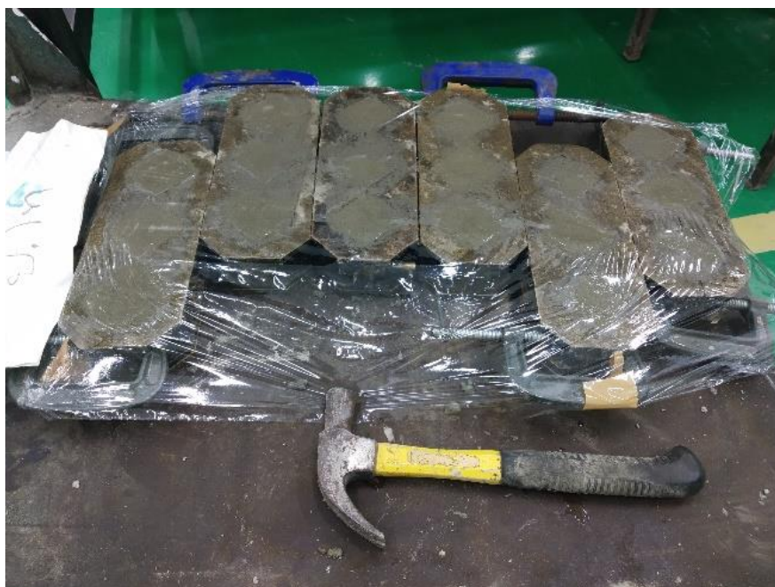
ภาพประกอบ 10 ตัวอย่างทดสอบกำลังอัดของมอร์ตาร์
