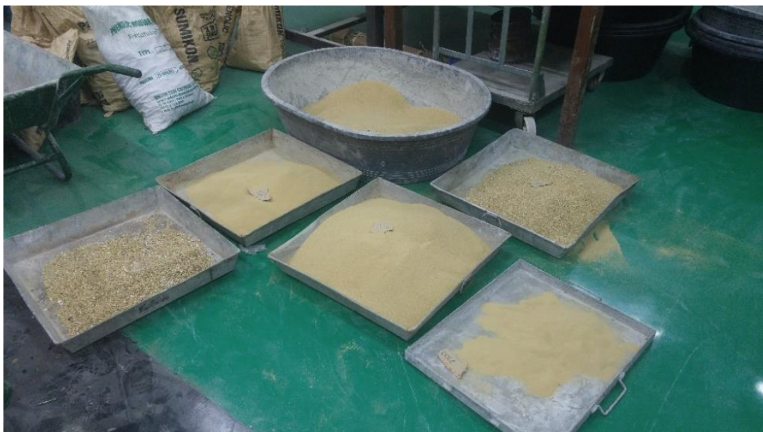
ภาพประกอบ 7 มวลรวมละเอียดที่ใช้ในการทดสอบ
