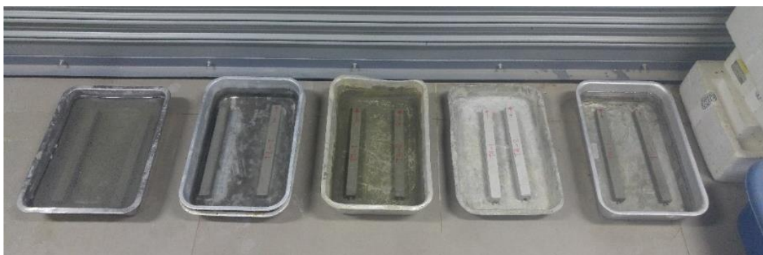
ภาพประกอบ 13 ตัวอย่างทดสอบการยึดหดตัวแบบแห้งของมอร์ตาร์
