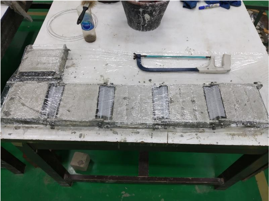
ภาพประกอบ 12 ตัวอย่างทดสอบกำลังดัดของมอร์ต้าร์
