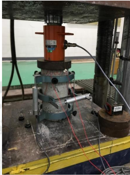
ภาพประกอบ 18 การทดสอบเพื่อหาค่าโมดูลัสยืดหยุ่น
