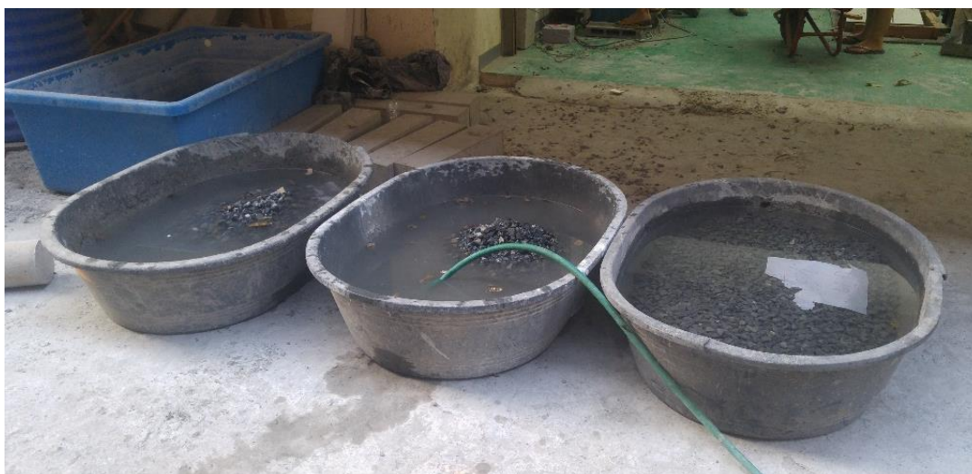
ภาพประกอบ 8 มวลรวมหยาบที่ใช้ในการทดสอบ
