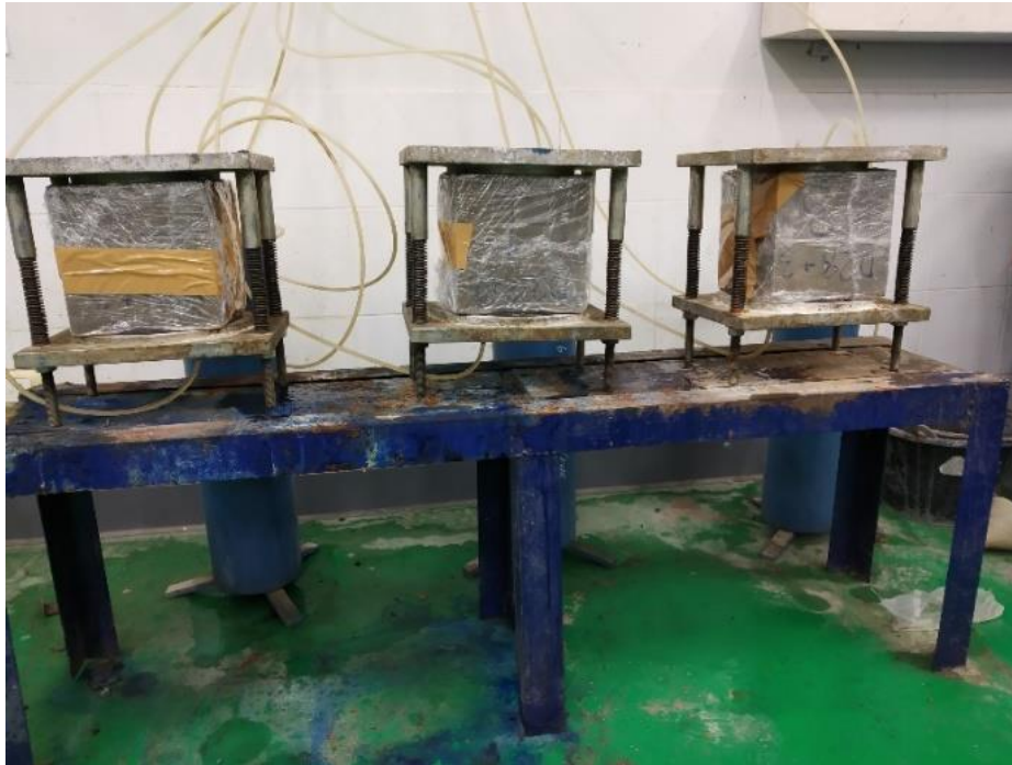
ภาพประกอบ 14 ตัวอย่างทดสอบการซึมผ่านของน้ำในมอร์ตาร์
