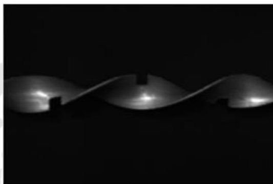
ภาพประกอบ 27 แผ่นไบบิตแบบตัดรูปสี่เหลี่ยมของ Murugesan และคณะ (2010) (27)
