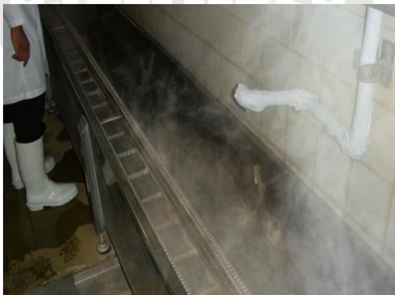
ภาพประกอบ 2 แสดงวิธีการผลิตน้ำร้อนโดยใช้สตีมน้ำ (2)
