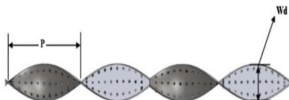
ภาพประกอบ 30 แผ่นใบพัดแบบเจาะรูของ Bhuiya และคณะ (2013) (30)
