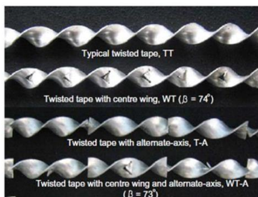
ภาพประกอบ 21 แผ่นใบบิดทดสอบของ Eiamsa-ard และคณะ (2010) (21)
