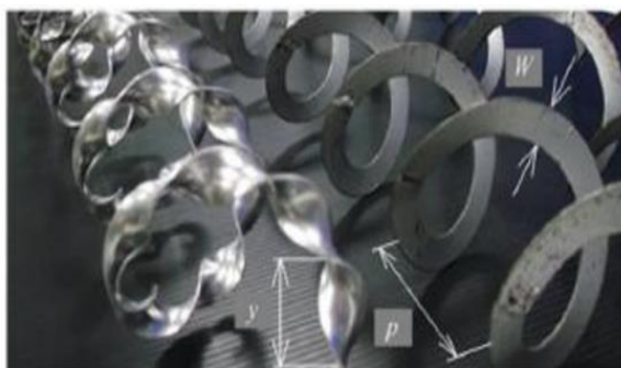
ภาพประกอบ 32 แผ่นบิดแบบเกลียว (HTT) และแผ่นแบบเกลียว (CHT) ของ Eiamsa-ard และคณะ (2012) (32)
