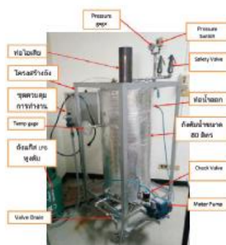
ภาพที่ 1 อุปกรณ์และส่วนประกอบของหม้อต้มน้ำที่พัฒนาขึ้น
