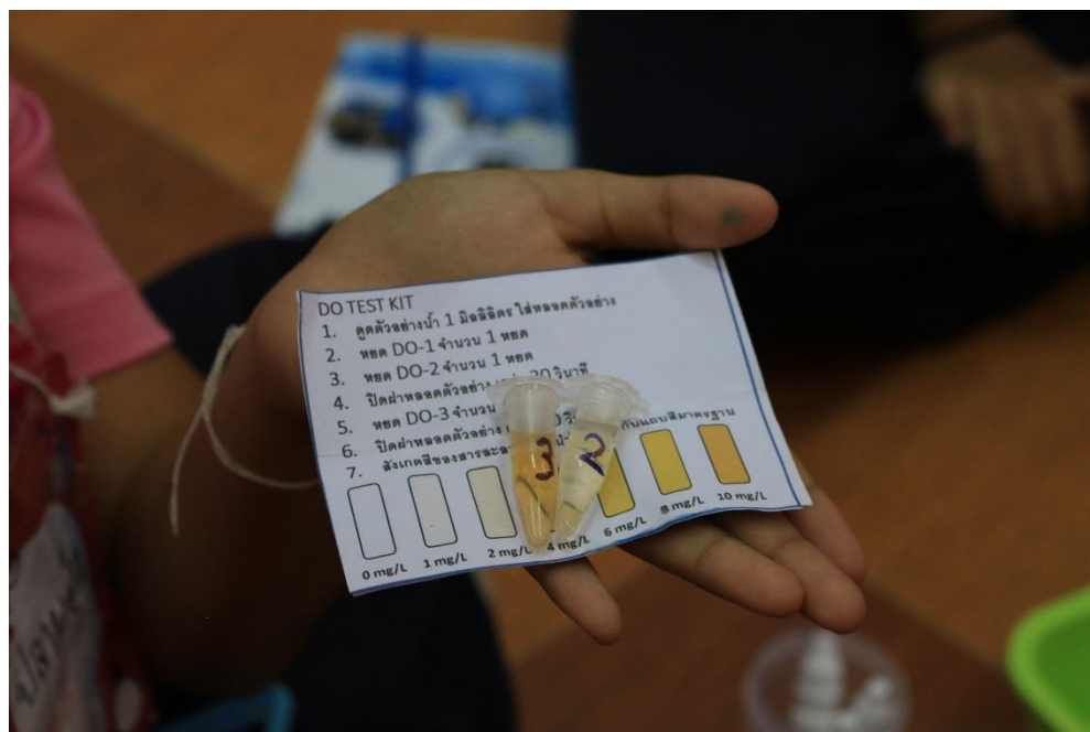
ตรวจค่าออกซิเจนละลายน้ำก่อนและหลังการทำงานของกังหันน้ำชัยพัฒนาจำลอง
