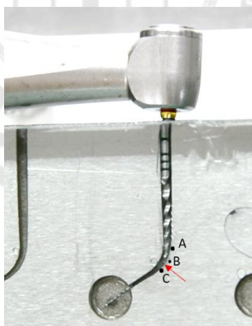
ภาพประกอบ 20 ตำแหน่งของไฟล์ที่หักในคลองรากฟันจำลอง
