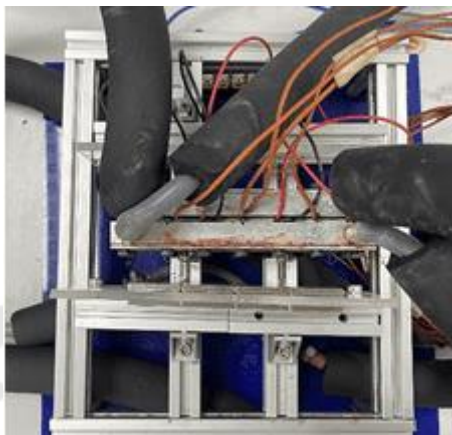
ภาพประกอบ 21 ภาพแสดงชุดระบายความร้อนที่ติดตั้งบนแม่เหล็ก
