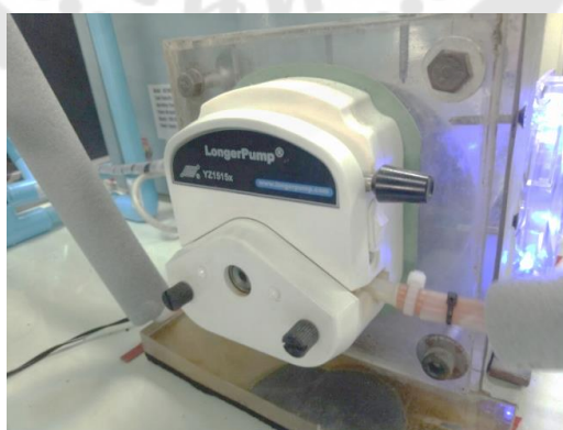
ภาพประกอบ 25 ปั๊มรีดสายยาง (Peristaltic pump)
