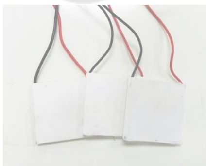
ภาพประกอบ 22 เทอร์โมอิเล็กทริกส์ (Thermoelectric)
