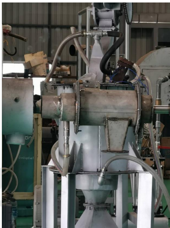
ภาพประกอบ จ.7 ประกอบเตาผลิตแก๊สเชื้อเพลิงสังเคราะห์เข้ากับเครื่องแลกเปลี่ยนความร้อน
