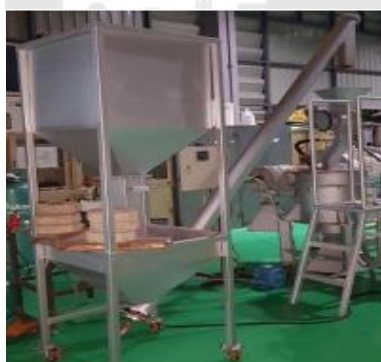
ภาพประกอบ 18 ชุดควบคุมอัตราการป้อนของชีวมวลอัดเม็ด
