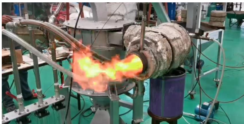
ภาพประกอบ จ.5 แก๊สเชื้อเพลิงสังเคราะห์สามารถติดไฟได้
