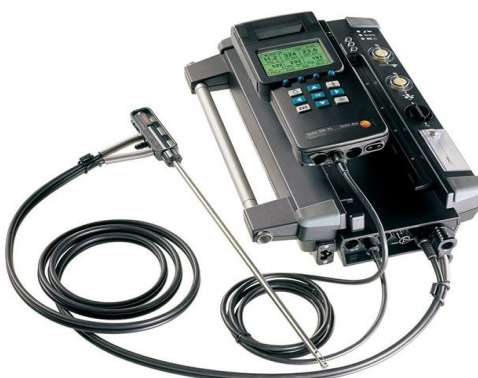
ภาพประกอบ 26 เครื่องวัดองค์ประกอบของแก๊สไอเสียจากปล่องอุตสาหกรรม ยี่ห้อ TESTO รุ่น 350 XL
