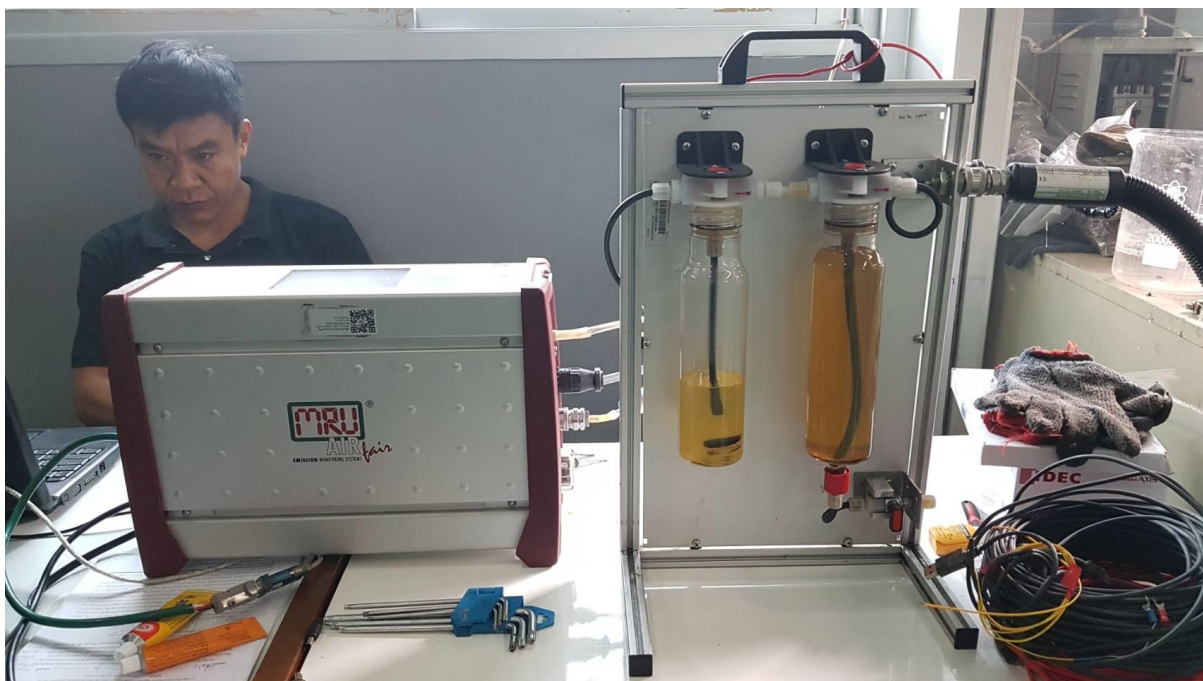
ภาพประกอบ 25 เครื่องวัดองค์ประกอบของแก๊สเชื้อเพลิงสังเคราะห์ (Syngas) ยี่ห้อ MRU รุ่น VARIO Plus
