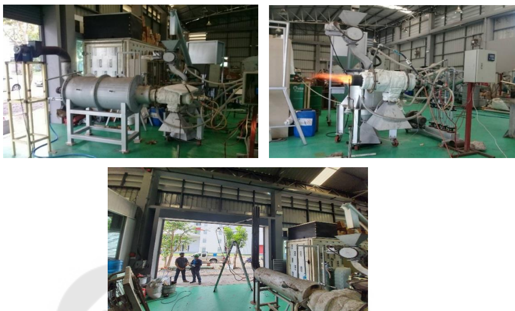
ภาพประกอบ 31 การทำงานของชุดอุปกรณ์ผลิตและเผาไหม้แก๊สเชื้อเพลิงสังเคราะห์ ต่อกับเครื่องแลกเปลี่ยนความร้อน
