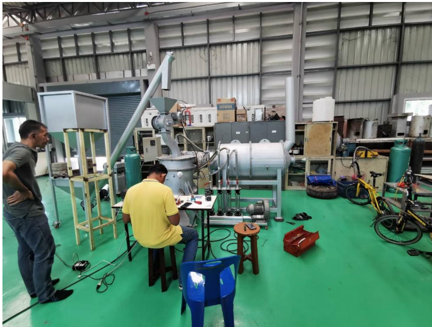
ภาพประกอบ จ.9 เก็บข้อมูลแก๊สเชื้อเพลิงสังเคราะห์และแก๊สไอเสีย
