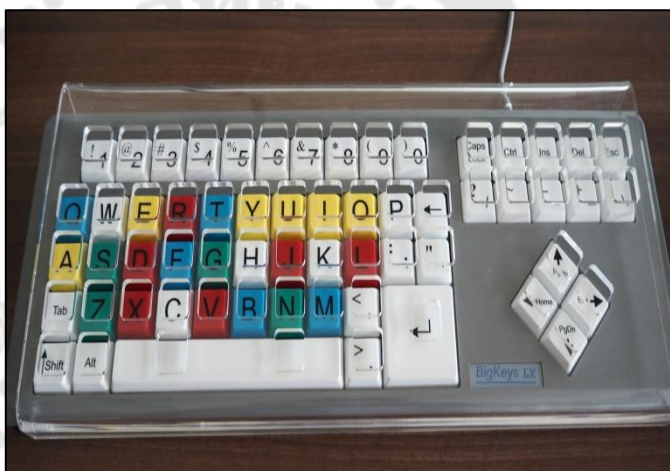
ภาพประกอบ 3 ตัวอย่างแป้นพิมพ์ที่มีอุปกรณ์ครอบแป้นพิมพ์ สำหรับการควบคุมให้คนพิการ พิมพ์ได้ตรงตำแหน่ง
