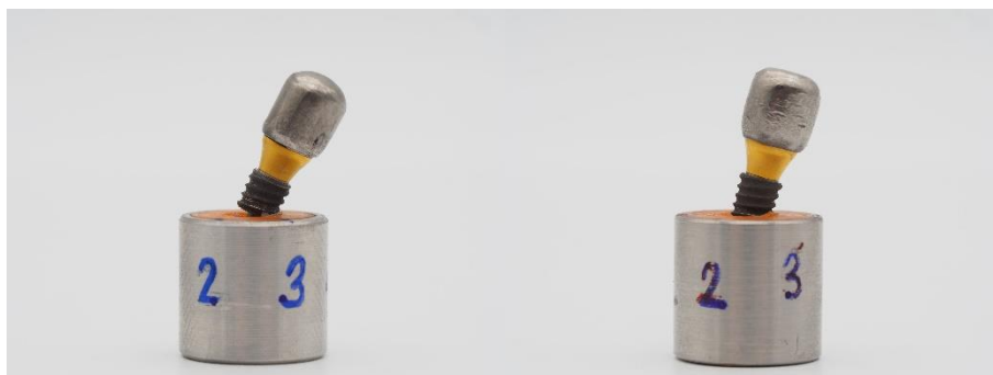
ภาพประกอบ 26 ตัวอย่างรูปแบบความล้มเหลว Ff กลุ่ม ND บริเวณ T5/T6
