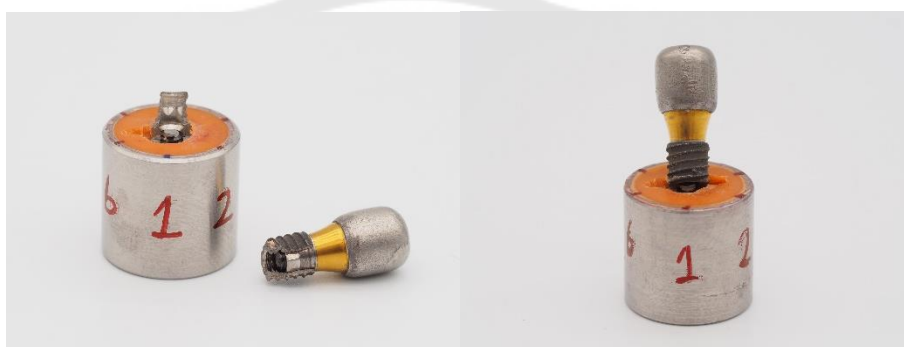
ภาพประกอบ 26 ตัวอย่างรูปแบบความล้มเหลว Ff กลุ่ม ND บริเวณ T5/T6
