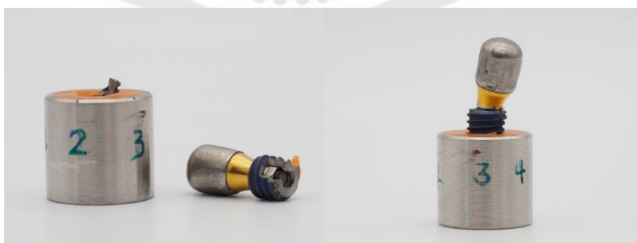
ภาพประกอบ 28 ตัวอย่างรูปแบบความล้มเหลว Ff กลุ่ม WD บริเวณ T5/6 ไปยัง T2/3 (ซ้าย) และ T5/6 ไปยัง T1 (ขวา)
