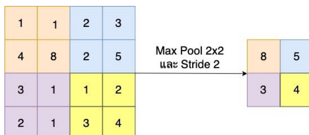
ภาพประกอบ 8 แสดงรูปภาพการจำลองของ Max Pooling
