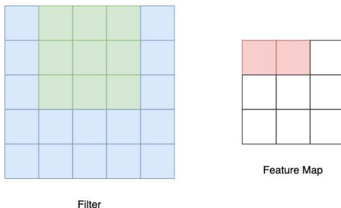
ภาพประกอบ 6 แสดงรูปภาพการทำงานของ Filter
