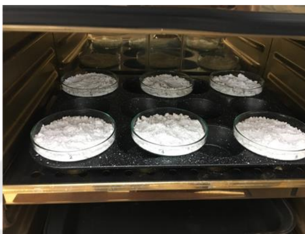
ภาพประกอบ 15 ผงอะลูมินาที่อุณหภูมิ 100^{\circ}\text{C}
