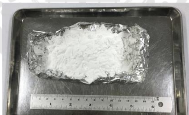
ภาพประกอบ 16 ส่วนผสมผงเซรามิกและพอลิไวนิลบิวทีรอล หลังจากทิ้งไว้ให้แห้งเป็นเวลา 1 วัน
