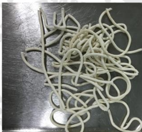
ภาพประกอบ 17 ลักษณะของ feedstock ที่ฉีดวนครบก่อนการขึ้นรูป
