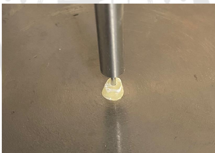
ภาพประกอบ 8 การทดสอบความแข็งแรงพันธะผลึกออกโดยใช้เครื่องทดสอบสากล
