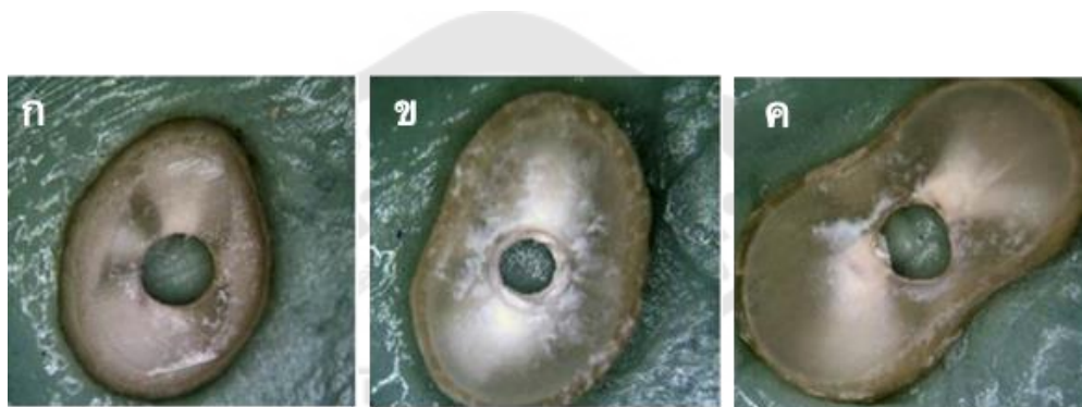
ภาพประกอบ 9 ชนิดความล้มเหลวหลังจากทดสอบความแข็งแรงพันธะผลึกออก [36]
