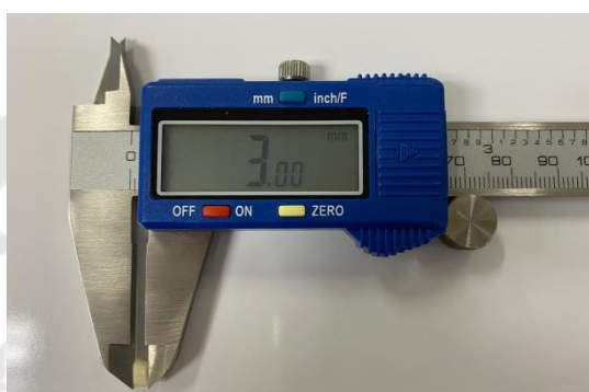
ภาพประกอบ 5 ภาพการวัดความหนาของแผ่นเนื้อฟันด้วยเครื่องมือเวอร์เนียคาลิเปอร์
