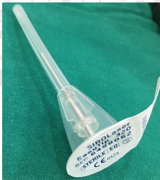
ภาพประกอบ 3 ภาพแสดงเส้นใยแก้วนำแสง (fiber optic ) ซึ่งเป็นส่วนเข้าทำงานของเครื่อง ไดโอดเลเซอร์ซีโรเลเซอร์บลู (Sirolaser Blue)
